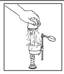
Coloque un recipiente sobre la VALVULA abierta para evitar derrames y abra y cierre el paso del agua varias veces. Deje el paso de agua cerrado.
