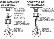
Utilice la arandela cónica en espiral existente. Es posible que la arandela cónica Fluidmaster no selle por completo en la línea de suministro de tipo espiral.
