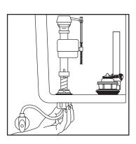
Una vez que las arandelas estén colocadas (vea el Paso 9a), apriete LA TUERCA DE ACOPLAMIENTO 1/4 de vuelta después de apretar al máximo con la mano. NO APRIETE EN EXCESO.
