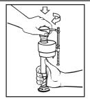
Vuelva a colocar la parte SUPERIOR encajando los bordes de sujeción y girando 1/8 de vuelta de izquierda a derecha. ASEGÚRESE DE QUE LA PUNTA QUEDE ORIENTADA HACIA LA POSICIÓN DE BLOQUEO. ES POSIBLE QUE LA VÁLVULA NO FUNCIONE SI LA PARTE SUPERIOR NO ESTA COMPLETAMENTE GIRADA HACIA LA POSICIÓN DE BLOQUEO.
