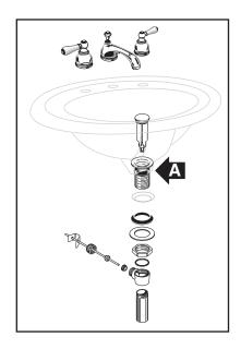
Placer le lavabo en position temporairement dans l'ouverture avant d'appliquer le scellant. Vérifier l'alignement et le dégagement. Ensuite, marquer le lavabo et le comptoir à plusieurs endroits pour définir l'emplacement de l'installation.
