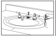
Raccorder le tuyau d'alimentation au robinet (en serrant à la main) et plier les tuvaux soigneuse-mentpour les engager dans les robinets d'arrêt. Resserrer les raccords aux niveaux du robinet et des robinets d'arrêt pour assurer l'étanchéité.
