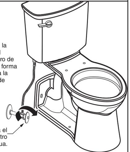
**⚠ ADVERTENCIA:** Si ajusta en exceso las tuercas de la línea del suministro de agua, podría haber roturas e inundación potencial. Si la conexión tiene fugas después de ajustar a mano, reemplace la línea de suministro. No use ningún tipo de sellador en la conexión del suministro de agua. El uso de masilla de plomero, grasa para tubería o cualquier otro tipo de sellador anulará la garantía.
