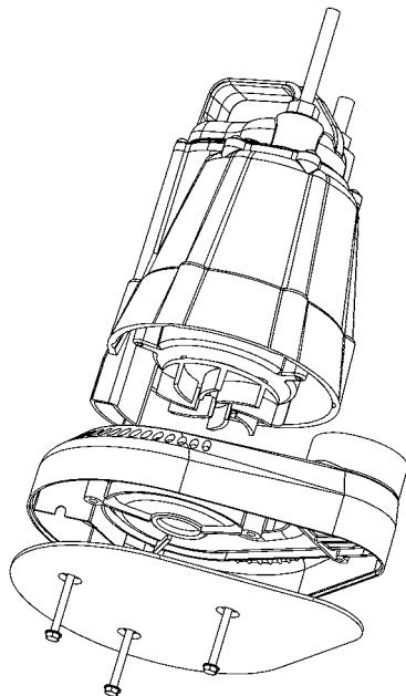
Le modèle S37-P ou S38 est une pompe automatique. Ce modèle est muni de deux cordons : un qui actionne l'interrupteur à flotteur et l'autre le moteur de la pompe. Le cordon de l'interrupteur est muni d'un connecteur en série (siamois) permettant de brancher le cordon de la pompe (moteur) sur son dos. Ce système a pour but de permettre le fonctionnement manuel de la pompe indépendamment de l'interrupteur au besoin.
