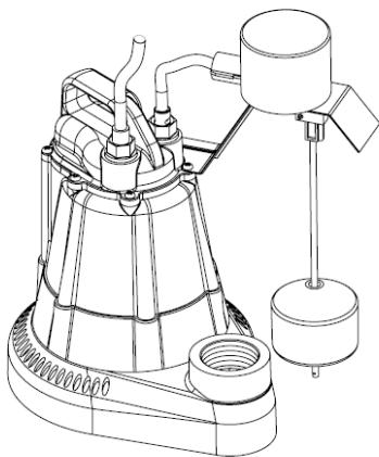
Le **modèles S37 et S37-P** possède un interrupteur à flotteur vertical intégré. La position d'arrêt peut être réglée en glissant un œillet de caoutchouc vers le haut ou vers le bas le long de la tige du flotteur.
