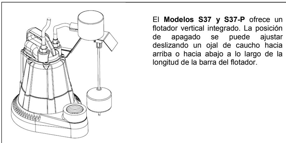
El **Modelos S37 y S37-P** ofrece un flotador vertical integrado. La posición de apagado se puede ajustar deslizando un ojal de caucho hacia arriba o hacia abajo a lo largo de la longitud de la barra del flotador.
