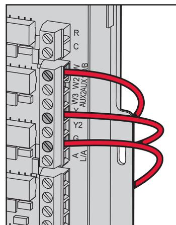
**Fig. 323. Inserting wires in EIM terminal block**
