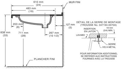
● Le haut du rebord avant doit être à 864 mm (34 po) maximum du plancher fini.
