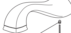
RP63510 Set Screw & Allen Wrench Tornillos de Ajuste y Llaves Vis de calage et Clés
