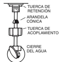
Estas piezas deben utilizarse de la manera en que se ilustra para asegurar una conexión estanca. Si se utiliza una tuercas de acoplamiento existente es posible que se produzcan fugas de agua. La tubería de suministro de agua debe penetrar al menos 1,25 cm (1/2 pulg.) en la parte roscada de la válvula (esto no se aplica a las tuberías con brida).
