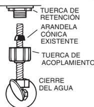
Utilice la arandela cónica en espiral existente. Es posible que la arandela cónica Fluidmaster no selle por completo en la línea de suministro de tipo espiral.
