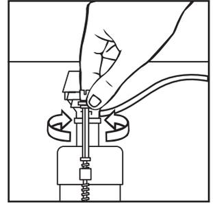
Abra el suministro de agua. Sumerja el tazón flotador en el agua por 30 segundos. Ajuste el agua al nivel deseado a devuelta la barra de ajuste de nivel y moviendo el tazón flotador hacia arriba o hacia abajo. El nivel de agua debe quedar de 1/2 a 1 pulg (1.3 a 2.5 cm) por debajo de la punta del tubo del rebosadero.
