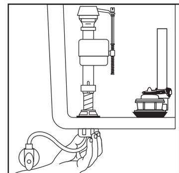
Una vez que las arandelas estén colocadas (vea el Paso 9a), apriete LA TUERCA DE ACOPLAMIENTO 1/4 de vuelta después de apretar al máximo con la mano. NO APRIETE EN EXCESO.
