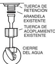
Utilice la tuercas de acoplamiento y la arandela existentes.
