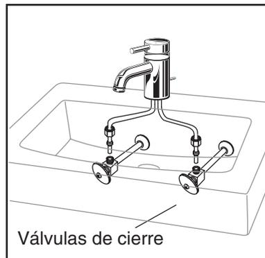
Conecte la línea de suministro al grifo (apriete firme con los dedos) y doble cuidadosamente los tubos para conectarlos con las válvulas de corte del suministro. Apriete las conexiones del grifo y las válvulas de corte para asegurar el sellado.
