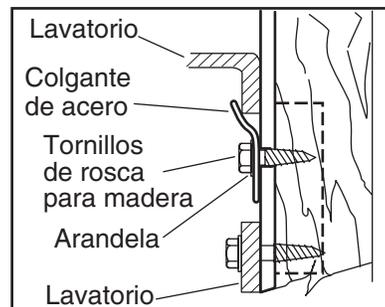
**IMPORTANTE:** El montaje final del método de tuercas y arandelas y tornillos rosca se muestra sólo para referencia.
