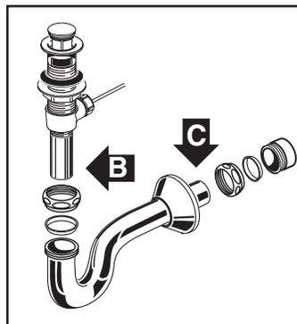
Conecte la trampa al conjunto del drenaje y ajuste con la mano para verificar la alineación. Puede que deba cortar parte de la cola (área "B") o parte de la pata horizontal de la trampa (área "C"). Ajuste las uniones para tener un ensamble hermético.
