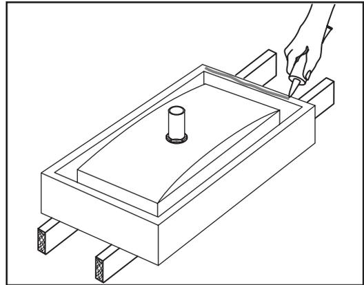
Después de verificar el ajuste y la alineación, coloque el lavabo al revés y aplique una generosa cantidad de adhesivo de silicona alrededor del lado inferior del borde. Vuelva a colocar el lavabo en su posición. Quite el exceso de adhesivo.
