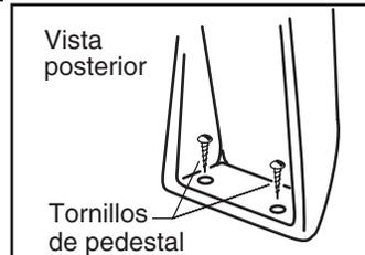
Instale los tornillos del pedestal. Ajuste firmemente las tuercas de anclaje o tornillos rosca del lavatorio.
