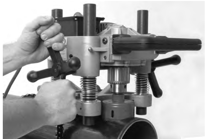
Figura 11 – Perforadora en funcionamiento
