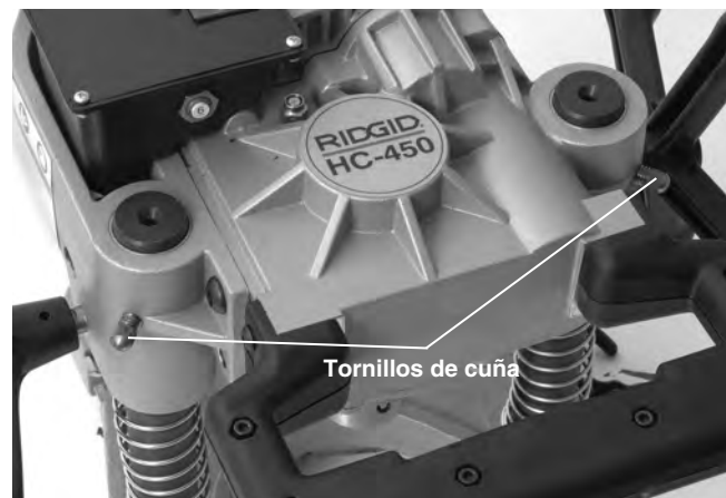
Figura 13 – Ajuste de los tornillos de cuña
