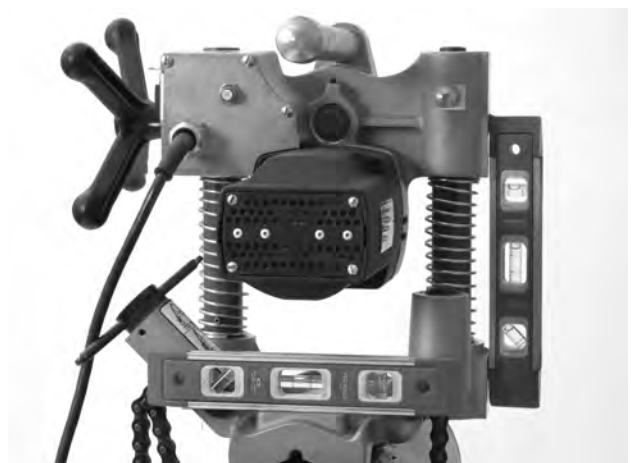
Figure 10 – Mise de niveau de la HC-300
