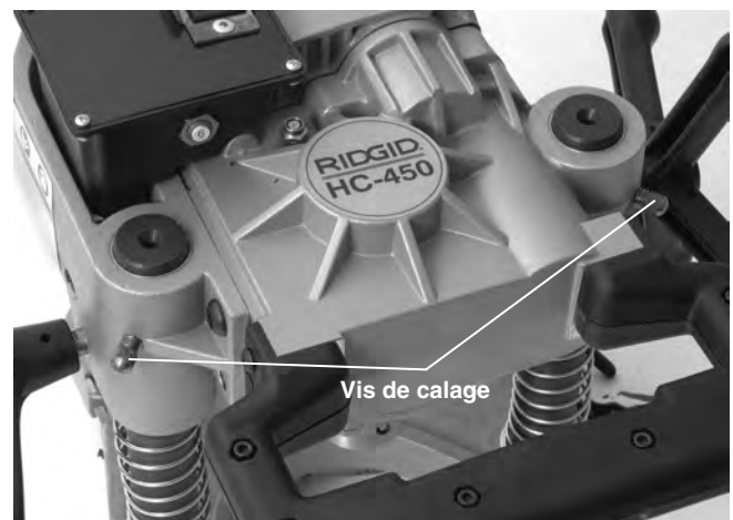
Figure 13 – Réglage des vis de calage
