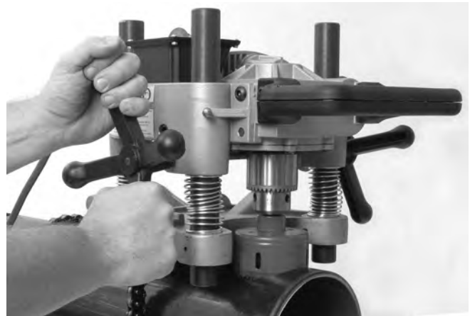
Figure 11 – Utilisation de la scie à cloche
