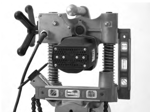
Figura 10 – Nivelación de la HC-300
