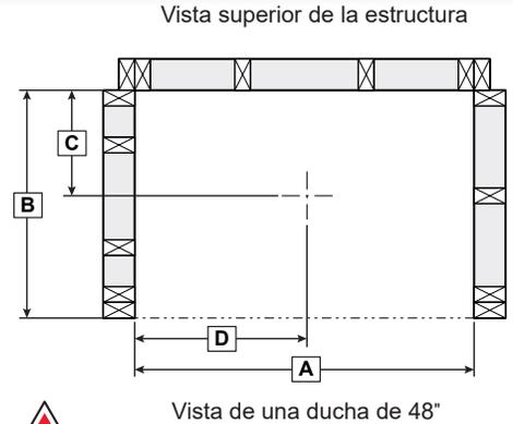
**!** Respetar la posición de los montantes al frente y en las esquinas interiores, los otros pueden variar.
