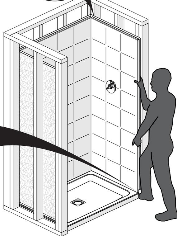
Faire des pré-trous dans la bride du mur de côté seulement (15), vis-à-vis de chaque montant avec une mèche de 1/8 po. **Ne pas percer les montants.** Fixer temporairement le mur de côté à un seul montant à l'aide d'une vis #8 x 1-3/4 po (non incluse).
