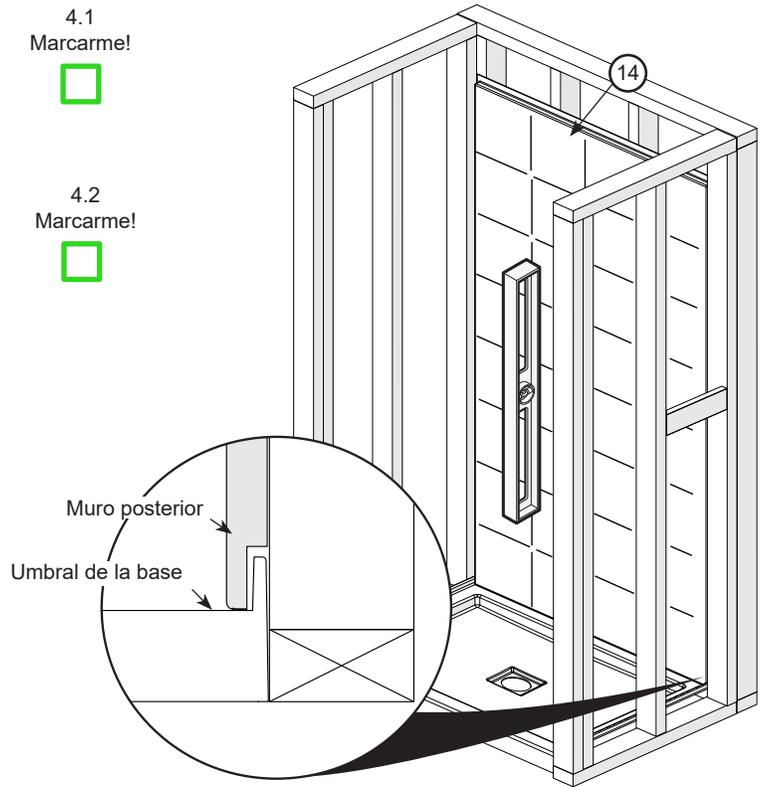
Perforar los pre-agujeros de la brida del muro posterior solamente con una broca de 1/8" alineando con cada montante. **No perforar los montantes.** Fijar el muro temporalmente a un montante usando un tornillo # 8 x 1 3/4" (no incluido).
