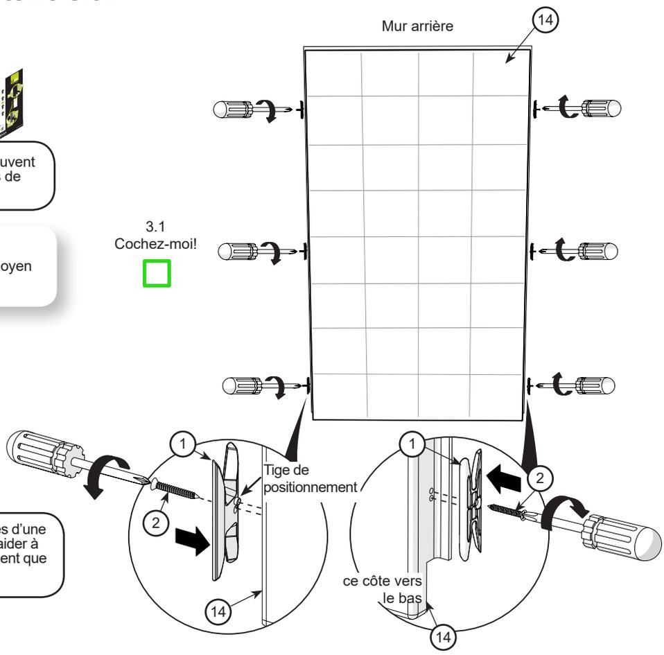
Installer trois chevilles d'ancrage (3) par mur de côté dans les trous prépercés, au moyen des vis fournies (4).
