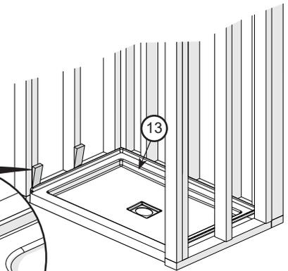
Percer des pré-trous dans la bride de la base seulement, avec une mèche de 1/8 po. **Ne pas percer les montants.** Fixer la base à tous les montants à l'aide de vis #8 x 1-3/4 po (non incluses).
