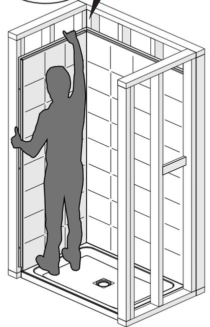
Instalar el muro lateral (15) que tiene los agujeros de la válvula. Poner el muro a aproximadamente 3" por encima del umbral de la base, empujarlo a fondo contra el muro posterior y descenderlo sobre el umbral de la base.
