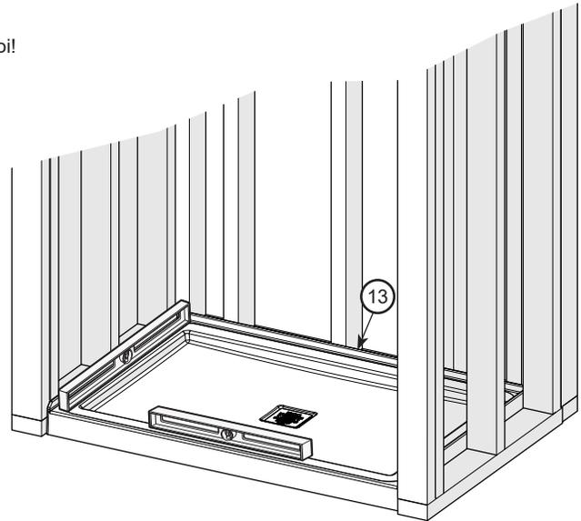
Soulever la base. Insérer des cales au sol sous le pourtour de la structure aux endroits précédemment marqués pour niveler la base. Abaisser la base et valider la mise de niveau et la stabilité de la base au sol. Si nécessaire, corriger avec des cales supplémentaires.
