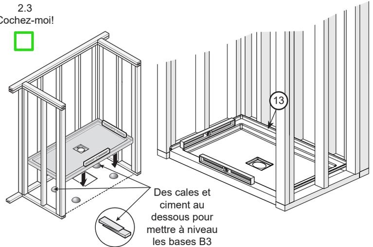
Des cales et ciment au dessous pour mettre à niveau les bases B3
