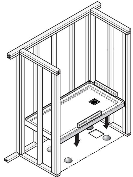
Si es necesario, utilizar cuñas de madera entre la base y los montantes para mantener la base en una posición centrada.
