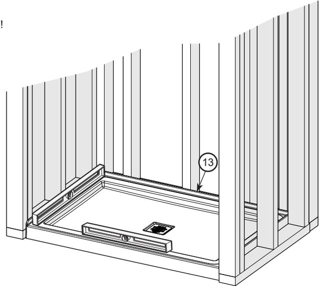
Levantar la base. Insertar cuñas de madera en el suelo alrededor del contorno de la base según necesidad para compensar la nivelación de la base. Bajar la base y validar la nivelación y la estabilidad de la base con el suelo. En caso de necesidad, corregir con cuñas adicionales.
