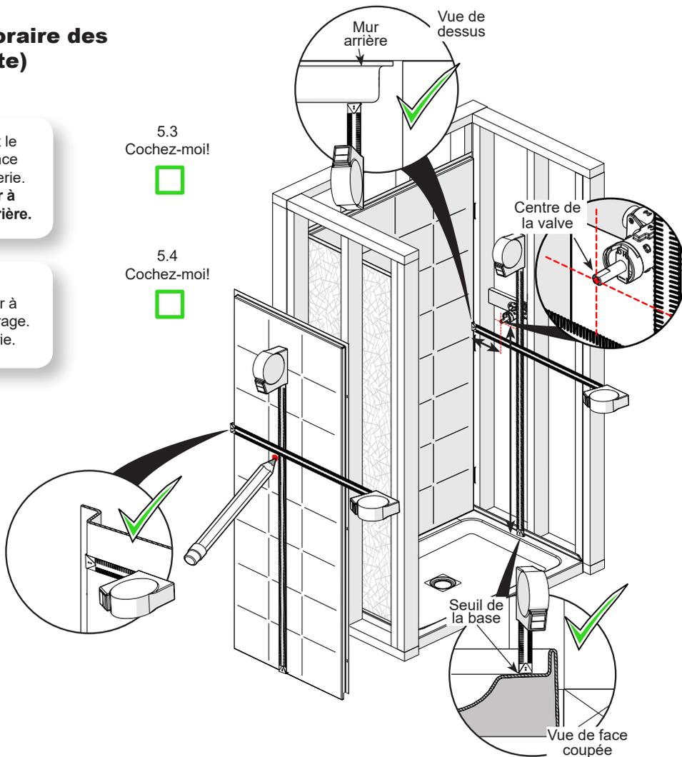
Perçer par l'avant les trous pour la robinetterie : Faire d'abord un preperçage à l'aide d'une mèche de 1/8 po. Utiliser une scie-cloche pour percer le trou de la robinetterie à l'endroit marqué. Consulter le guide d'installation de la robinetterie pour connaître la taille nécessaire de la scie-cloche.
