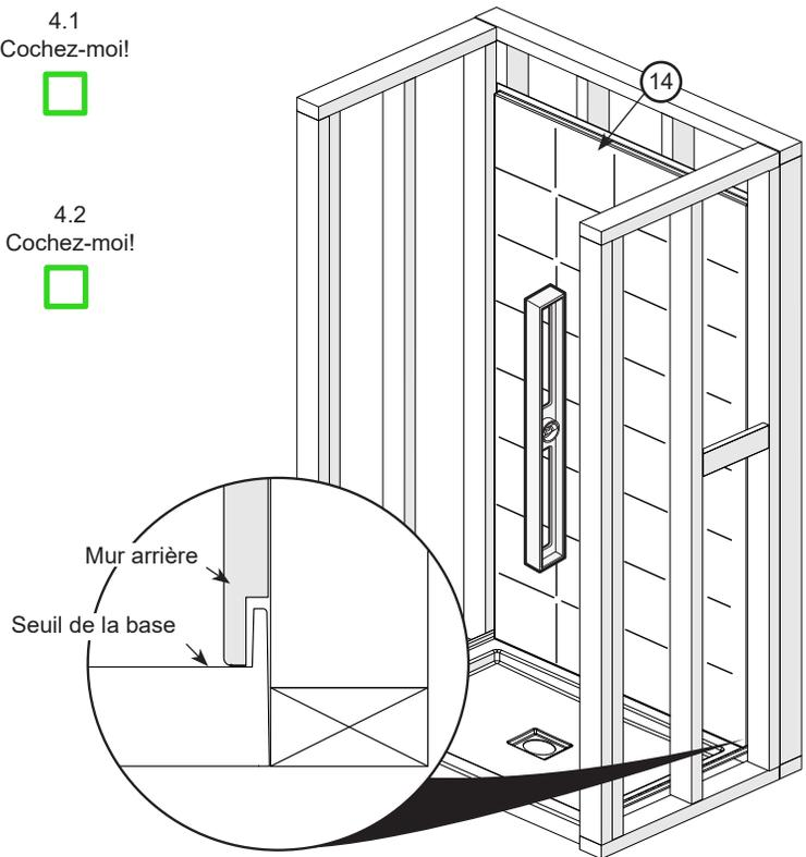
Faire des pré-trous dans la bride du mur arrière seulement (14), vis-à-vis de chaque montant avec une mèche de 1/8 po. **Ne pas percer les montants.** Fixer temporairement le mur arrière à un seul montant à l'aide d'une vis #8 x 1-3/4 po (non incluse).
