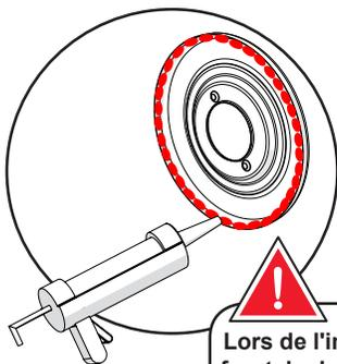
Lors de l'installation de la plaque frontale de la valve ou d'autres composants, appliquer du silicone sur le bord extérieur.
