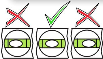
**!** Es esencial que el suelo esté a nivel para garantizar una instalación alineada. Cemento autonivelante puede ser usado para nivelar el piso. Tenga cuidado de no bloquear la posición de la abertura del desagüe.
