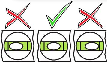
**!** Es esencial nivelar el muro posterior para garantizar el alineamiento de los muros laterales.
