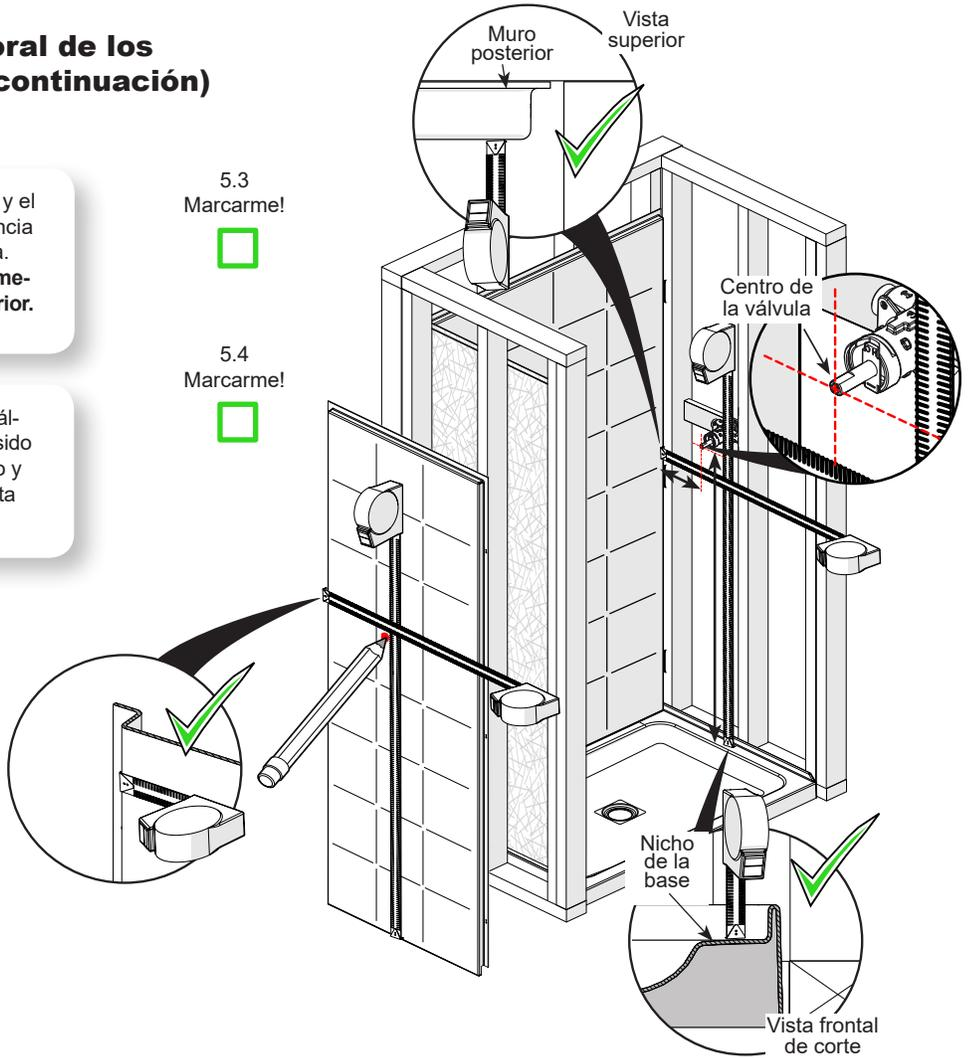
Perforar desde el frente los huecos para las válvulas: Hacer primero una pre perforación con una broca de 1/8". Usar una sierra de perforación para perforar el orificio de la válvula en el sitio marcado. Consultar la guía de instalación de la válvula para conocer el tamaño apropiado de la sierra de perforación.
