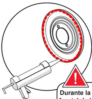
Durante la instalación de la placa frontal de la válvula o de los otros componentes, aplicar silicona en el borde exterior.
