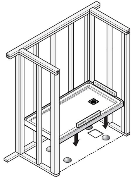
Au besoin, utiliser des cales de bois entre la base et les montants pour maintenir la base en position centrée.
