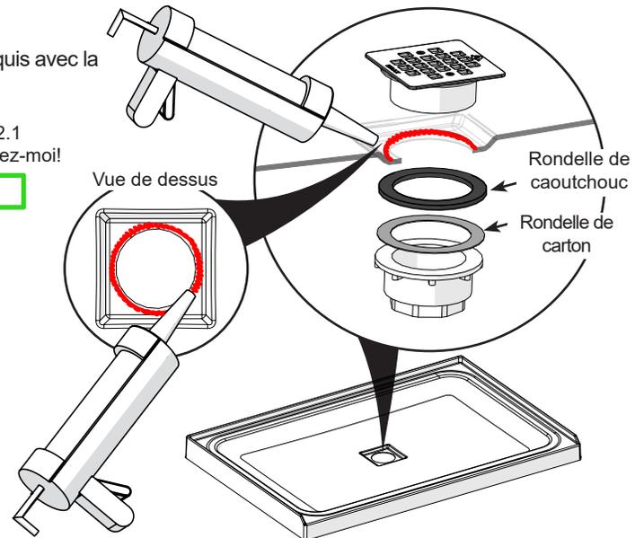
Position du drain varie en fonction du modèle de la base
