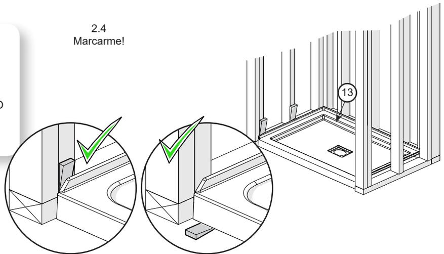
Perforar los pre-agujeros de la brida de la base solamente con una broca de 1/8". **No perforar los montantes.** Fijar la base a todos los montantes usando tornillos # 8 x 1 3/4" (no incluidos).
