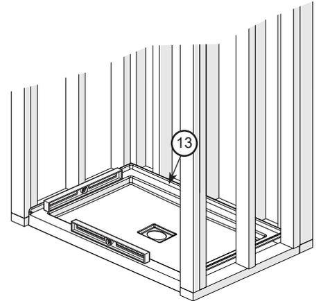
Au besoin, utiliser des cales de bois entre la base et les montants pour maintenir la base en position centrée.
