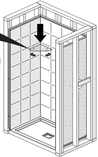
Insertar las tapas de fijación de la repisa (9) en las arandelas (8). Alinear los agujeros de la repisa y los de los soportes (6) e insertar el ensamble de la tapa (9). Bajo la repisa, insertar los tornillos #10 x 1/2" (10) y apretar con la llave allen (11).
