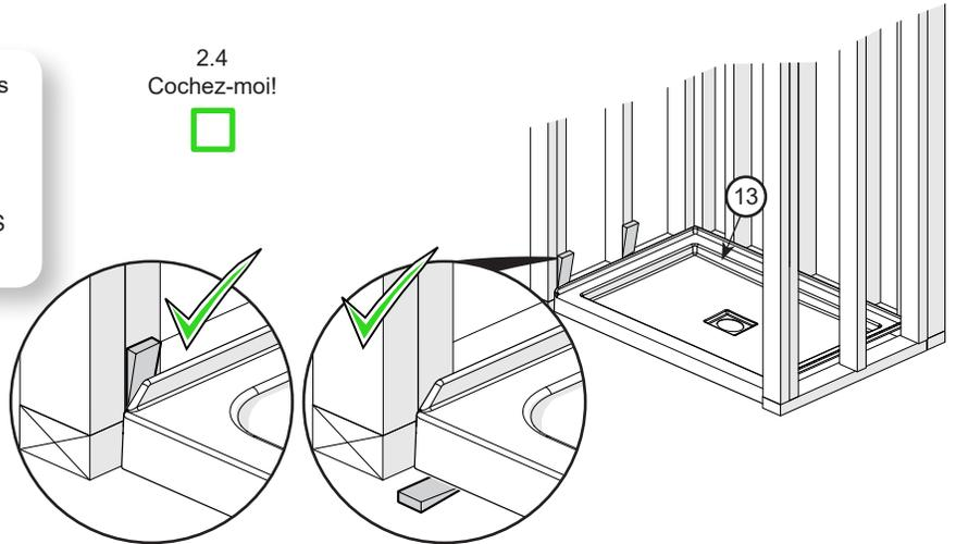
Percer des pré-trous dans la bride de la base seulement, avec une mèche de 1/8 po. **Ne pas percer les montants.** Fixer la base à tous les montants à l'aide de vis #8 x 1-3/4 po (non incluses).
