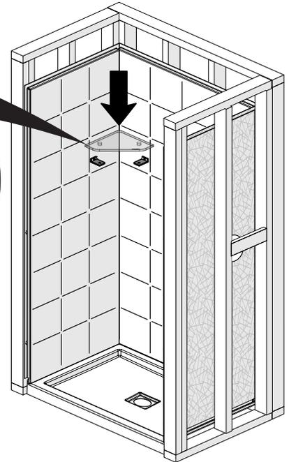
Insérer les bouchons (9) dans les rondelles (8). Aligner les trous de la tablette et ceux des supports (6), puis y insérer l'assemblage du bouchon (9). Sous la tablette, insérer les vis #10 x 1/2 po (10) et serrer avec la clé hexagonale (11).
