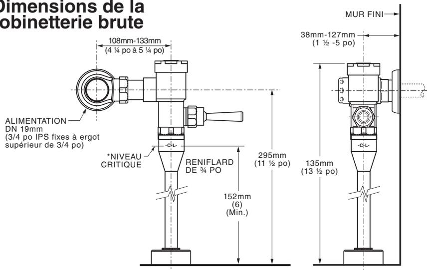
\*Remarque : La ligne critique (-C-L-) sur le reniflard doit se trouver généralement à au moins 6 po (152 mm) au-dessus de l'installation fixe. Pour de plus amples détails, consulter le code.
