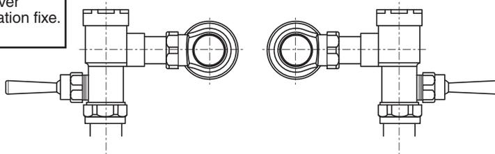
Voir (Section 8) pour convertir le robinet de chasse d'eau en une installation pour gaucher.
