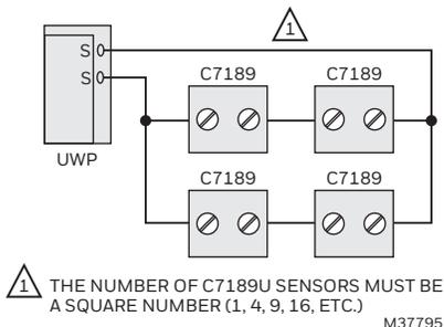
**Fig. 39. Wiring 4 C7189U sensors.**
