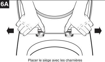
Placer le siège avec les charnières dans la cuve. Aligner le siège avec le devant de la cuve.
