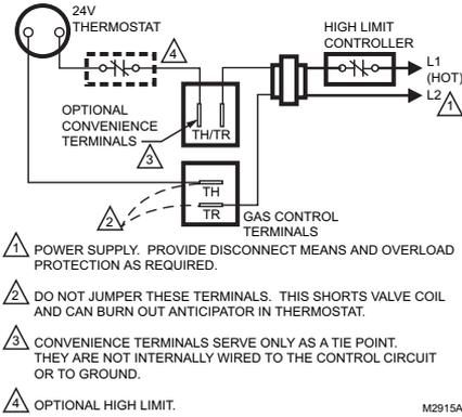
**Fig. 8. Wiring Connections.**
