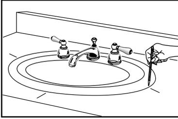
**6** Raccorder le tuyau d'alimentation au robinet (en serrant à la main) et plier les tuyaux soigneusement pour les engager dans les robinets d'arrêt. Resserrer les raccords aux niveaux du robinet et des robinets d'arrêt pour assurer l'étanchéité.
