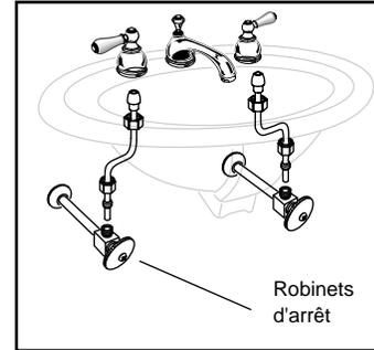
**5** Après avoir vérifié l'ajustement et l'alignement, retourner le lavabo à l'envers et appliquer généreusement le scellant sous le contour du lavabo près du bord. Abaisser soigneusement le lavabo en place, en alignant les marques faites auparavant, et presser fermement. Laisser le scellant prendre avant de raccorder les tuyaux d'alimentation et le vidage.
