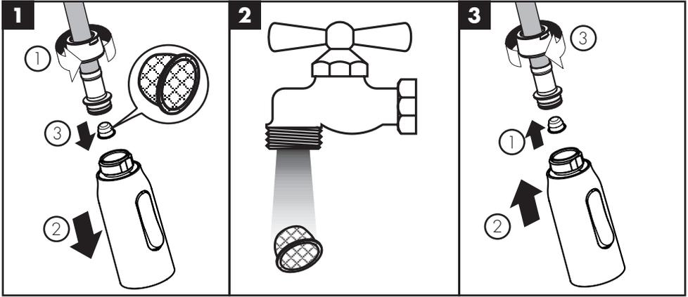
**Check valve maintenance / Entretien de les clapets anti-retour / Mantenimiento de las válvulas antirretornos**
