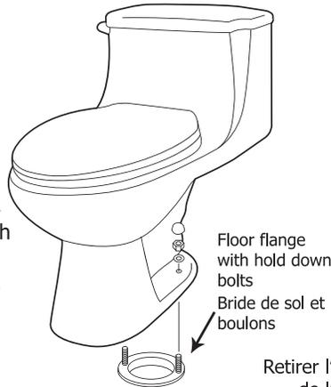
Glisser deux boulons neufs dans les trous de la bride de sol, en utilisant du mastic au besoin pour les maintenir en position verticale. Appliquer du mastic de plombier sur le pourtour de la base de la cuvette, saisir et retourner la cuvette puis la déposer délicatement au-dessus des boulons verticaux de la bride de sol. Le joint de cire doit s'emboîter parfaitement dans la bride de sol.
