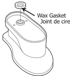
Placer la nouvelle cuvette à l'envers sur une pile de journaux et glisser un joint de cire neuf, côté effilé vers le haut, sur l'ouverture de sortie.
