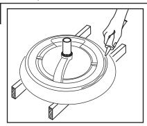
Après avoir vérifié l'ajustement et l'alignement, retourner le lavabo à l'envers et appliquer généreusement le scellant sous le contour du lavabo près du bord.
