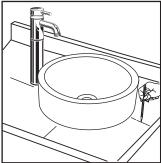
Placer le lavabo en position temporairement dans l'ouverture avant d'appliquer le scellant. Vérifier l'alignement et le dégagement. Ensuite, marquer le lavabo *et* le comptoir à plusieurs endroits pour définir l'emplacement de l'installation.
