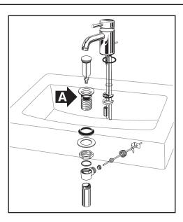
Installer le robinet et l'assemblage de drain (non inclus) dans le lavabo ou sur le plan de travail selon les instructions du fabricant. Bien s'assurer d'appliquer un trait de scellant sous le rebord de la garniture du vidage (A) afin que le joint soit étanche entre le lavabo et le vidage. Enlever l'excédent de scellant après avoir installé le vidage sur le lavabo.
