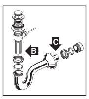
Raccorder le siphon à l'assemblage du vidage en serrant à la main pour vérifier l'alignement. Il pourrait être nécessaire de couper une partie de la crépine d'aspiration (B) ou une partie du tuyau horizontal du siphon (C). Resserrer les joints pour un assemblage étanche.
