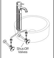
Raccorder le tuyau d'alimentation au robinet (en serrant à la main) et plier les tuyaux soigneusement pour les engager dans les robinets d'arrêt. Resserrer les raccords aux niveaux du robinet et des robinets d'arrêt pour assurer l'étanchéité.
