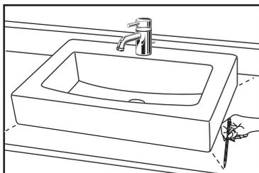
**5** Après avoir vérifié l'ajustement et l'alignement, renverser l'évier et étendre une portion généreuse d'adhésif à base de silicone autour du rebord. Remettre l'évier en place. Essuyer l'excès d'adhésif.
