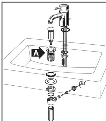
Poser le robinet et le drain (non compris) sur l'évier conformément aux directives du fabricant. Appliquer un ruban de mastic sur le côté inférieur du tuyau d'évacuation (partie « A ») afin d'assurer une étanchéité parfaite entre l'évier et le tuyau d'évacuation. Enlever l'excès de mastic après l'installation du tuyau d'évacuation sur l'évier.
