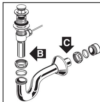
Raccorder le siphon au tuyau d'évacuation en serrant manuellement pour vérifier l'alignement. Il sera peut-être nécessaire de couper une partie de la pièce de raccordement (section « B ») ou une partie de la patte horizontale du siphon (section « C »). Serrer les joints pour que l'ensemble soit étanche.
