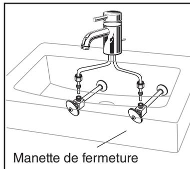
Raccorder la conduite d'alimentation au robinet (serrer à la main) et délicatement courber les tuyaux afin de pouvoir engager avec les robinets de fermeture d'alimentation. Serrer les raccords au robinet et les robinets de fermetures pour fixer le joint d'étanchéité.
